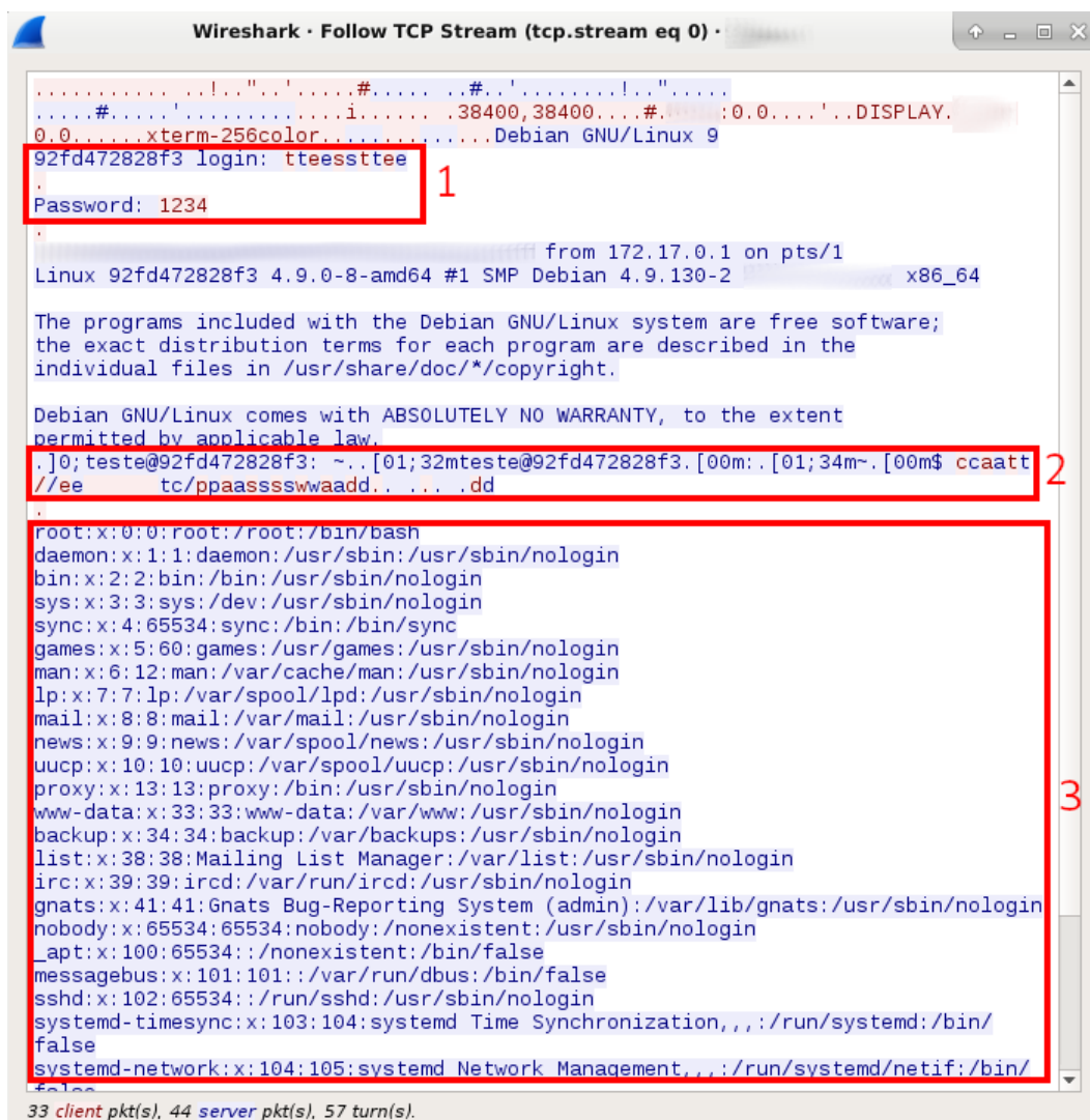
Figura 50: Captura de tráfego com conexão Telnet.
