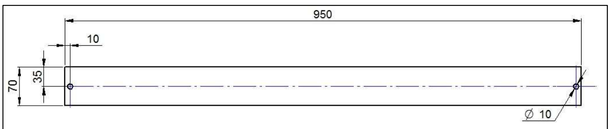
Figura 19. Representação do corpo de prova de chapa submetidos ao ensaio de atrito (TAVARES 2019).
