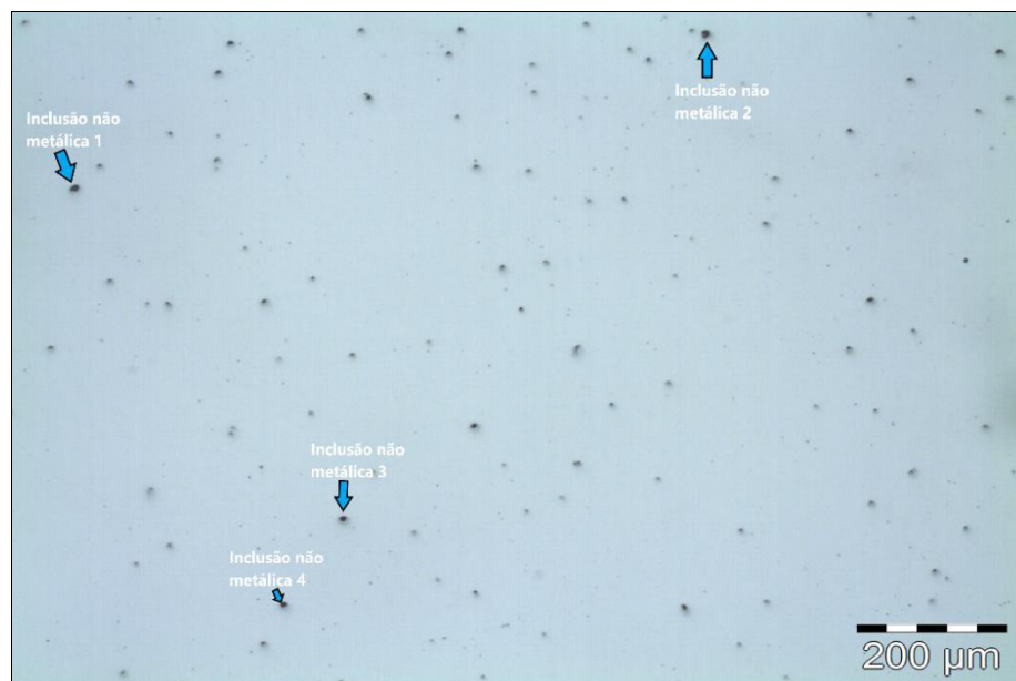
Figura 28. Microscopia ótica da amostra de chapa retirada da bobina NBR 5915 sem ataque químico, evidenciando inclusões não metálicas presentes na microestrutura.
