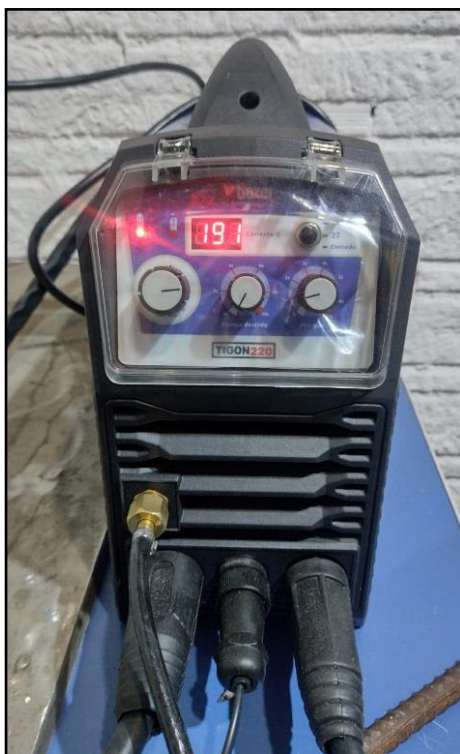
Figura 24 - Máquina de solda utilizada para realizar o pontemaneto nos vergalhões
