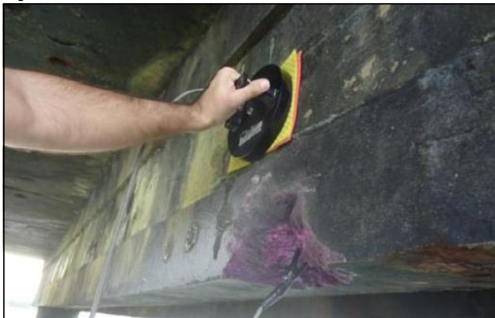
Figura 21 - Ensaio de velocidade de corrosão
