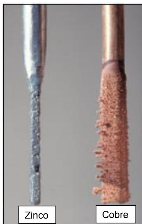
Figura 8 - Eletrodo após funcionamento da pilha
