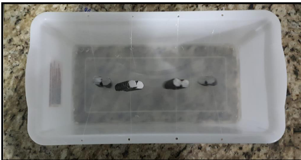
Figura 35 - Amostras posicionadas para o ensaio de imersão em NaCl
