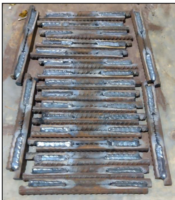
Figura 27 - Vergalhões submetidos ao processo de soldagem
