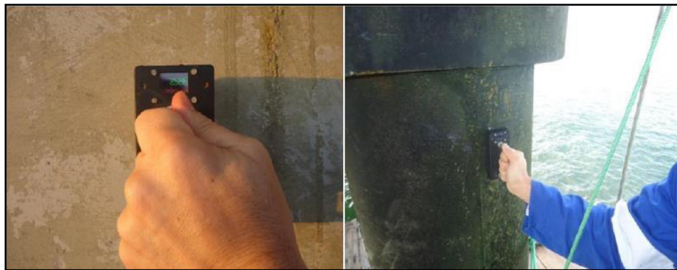
Figura 19 - Ensaio de Resistividade
