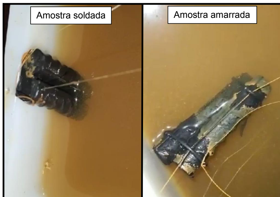
Figura 72 - Amostras corroídas após 3 meses de imersão em NaCl
