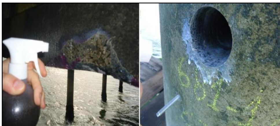
Figura 11 - Ensaio colorimétrico de aspersão de nitrato de prata
