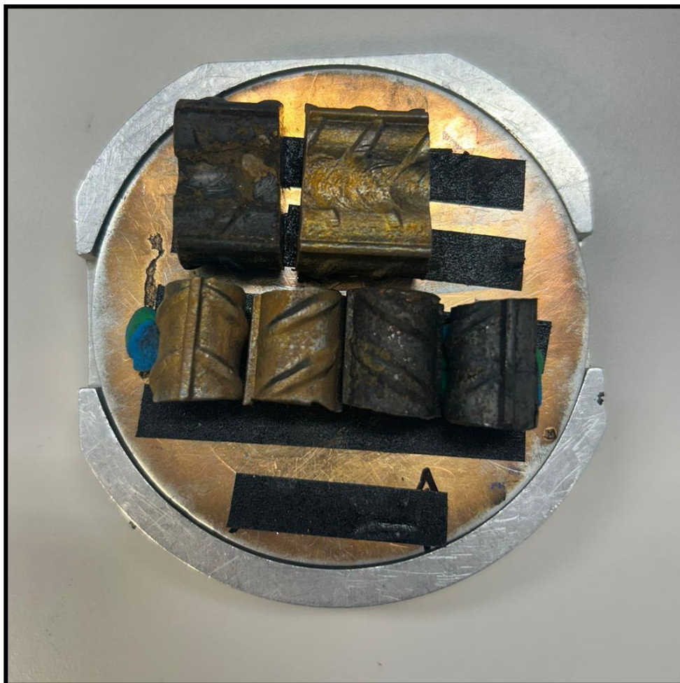
Figura 48 - Amostras preparadas para ensaio MEV após corrosão
