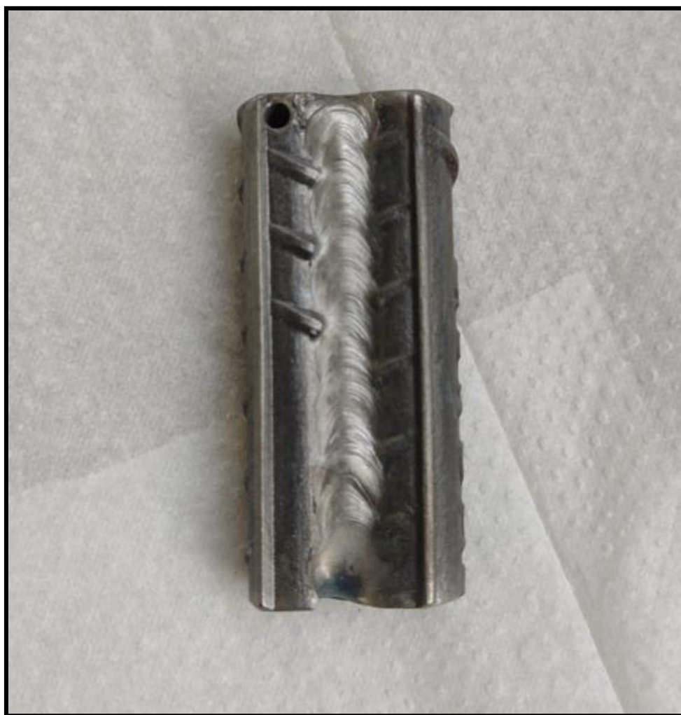
Figura 49 - Amostra preparada para ensaio MEV antes da corrosão
