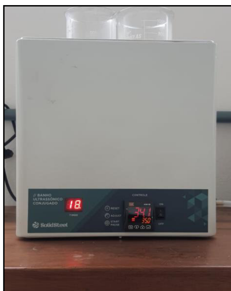
Figura 33 - Equipamento de Banho Ultrassônico Com Aquecimento utilizado
