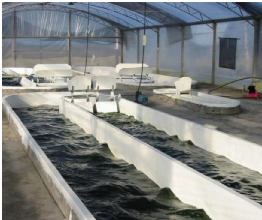
Figura 12 – Tanques de cultivo de microalgas em biorreatores abertos em Santa Vitória do Palmar/RS
