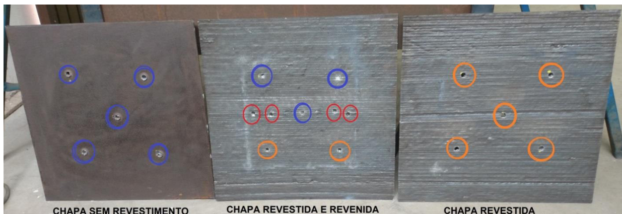
Figura 42 – Situação das chapas após o teste balístico
