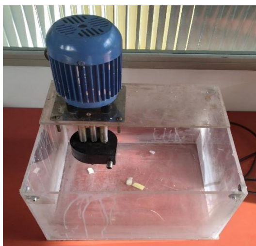
Figura 15 - Tanque e bomba utilizados para resfriamento.
