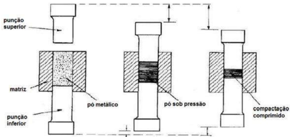
Figura 6. Exemplo esquemático da operação de compressão
