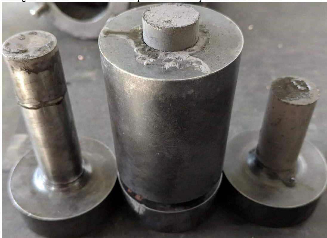
Figura 20. Matriz uniaxial de duplo efeito e compactado verde
