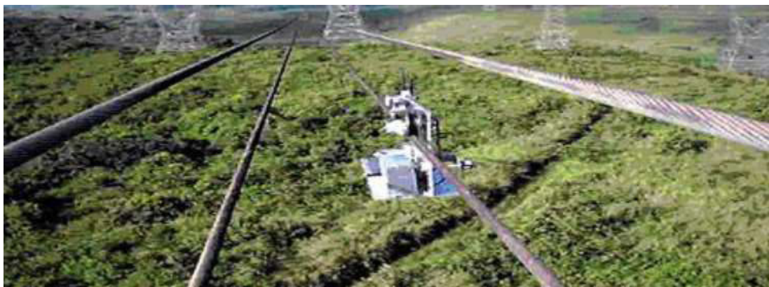
Figura 2 - Foto do robô durante seu movimento sobre o condutor
