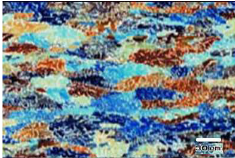
Figura 16 – Grão colunar de Alumínio.
