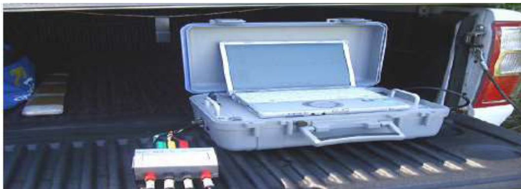
Figura 1– Equipamento Field Machine Compact + notebook em um ensaio em campo
