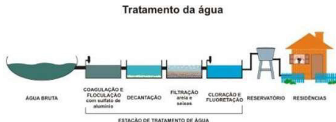
Figura 1. Fluxograma genérico do tratamento em ciclo completo (SANEP, 2022).
