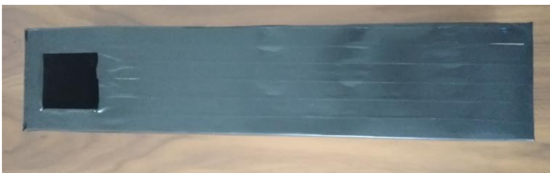
Figura 31 - Periscópio de baixo custo, construído com: papel cartão preto (parte interna), espelho, cola, e fita adesiva.
