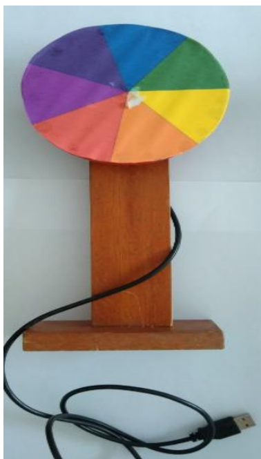
Figura 38 – Disco de Newton produzido com material de baixo custo.
