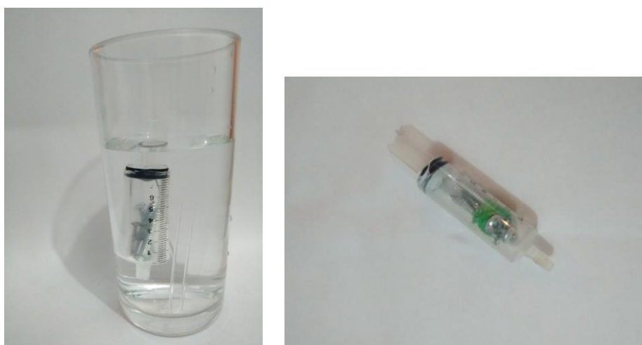
Figura 82 – Objeto interno da garrafa pet com água, para a construção do ludião: etapa de calibragem.
