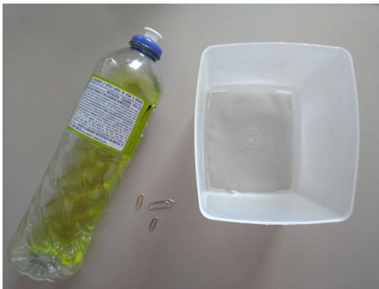
Figura 72 – Kit experimental para o experimento sobre a tensão superficial da água e a flutuação de clips: recipiente com água, clips e detergente.
