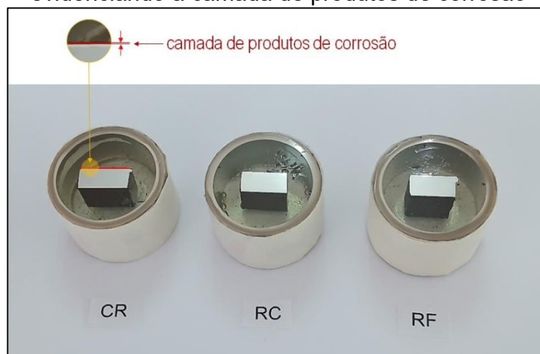
Figura 11 – Amostras CR, RC e RF do aço patinável AHSS 750WP embutidas em resina epóxi, em seção transversal, após 6 meses de exposição atmosférica, evidenciando a camada de produtos de corrosão
