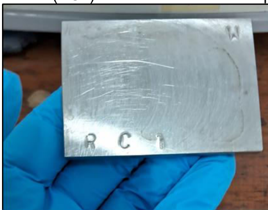
Figura 5 – Corpo de prova do aço patinável AHSS 750WP, identificado por punção alfanumérica (RC1) antes do tratamento superficial
