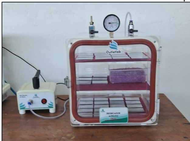
Figura 6 – Corpos de prova do aço patinável AHSS 750WP limpos e armazenados em dessecador a vácuo antes do tratamento superficial
