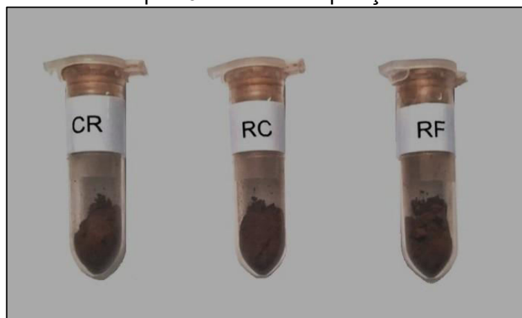
Figura 12 – Amostras CR, RC e RF do aço patinável AHSS 750WP, na forma de pó, após 6 meses de exposição
