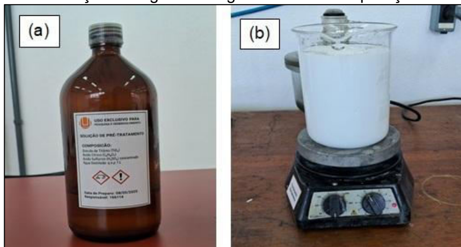
Figura 7 – (a) Solução de pre-rusting formulado; (b) etapa da homogeneização da solução em agitador magnético antes da aplicação
