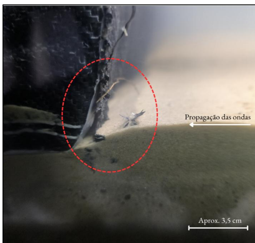
Figura 48 - Cavidade erosiva formada junto à geoforma têxtil no ensaio bs2-T4 , evidenciando escavação a montante e lateral da estrutura.
