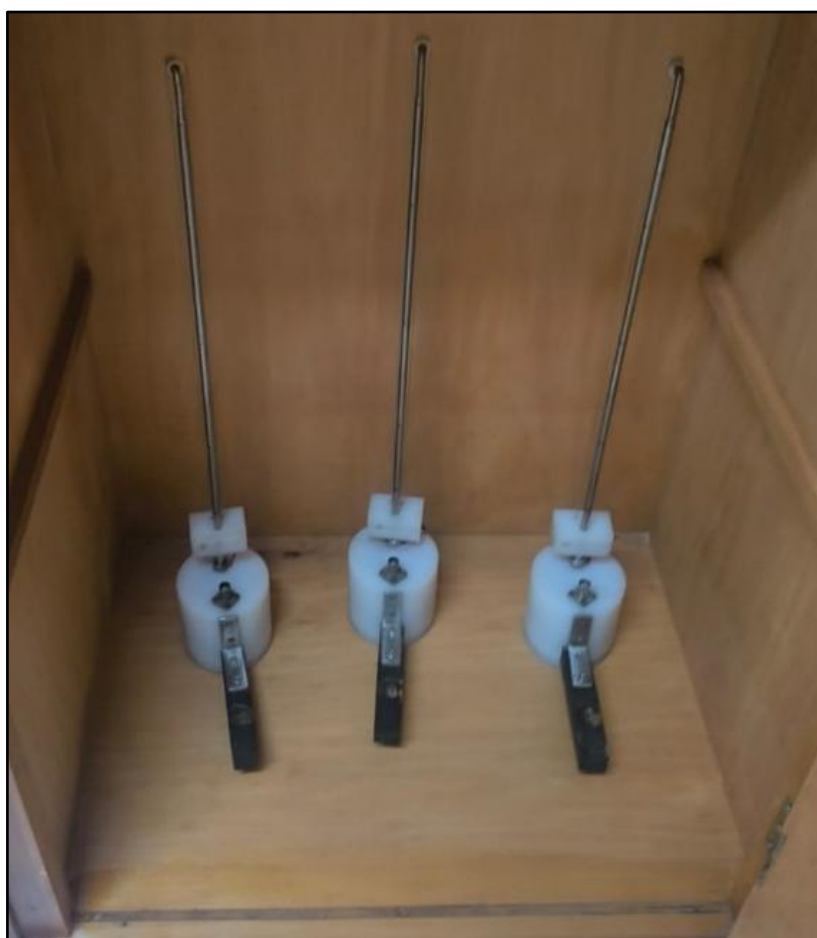
Figura 34 – Sensores do tipo Waveprobe utilizados na aquisição dos dados. Fonte: Autor, 2025.
