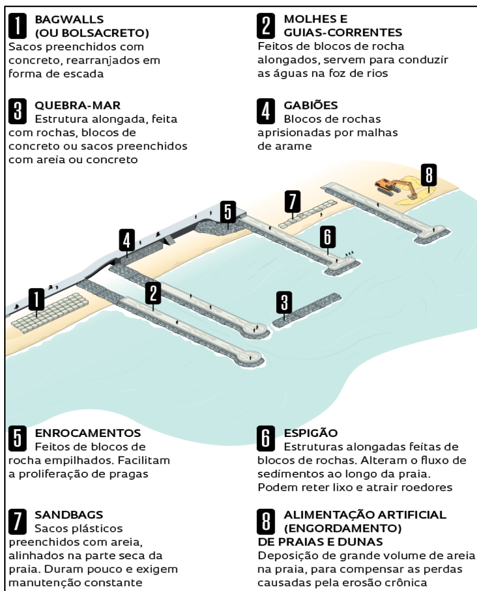
Figura 7 – Exemplo esquemático de aplicações de estruturas rígidas. Fonte: Souza (2023)
