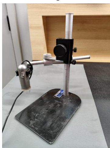
Figura 22 – Lupa modelo Dino-Lite AM4113ZT utilizado para registro das macrografias.
