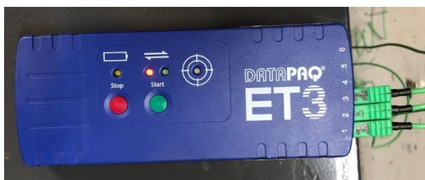
Figura 19 – Termógrafo utilizado na criação do perfil de tempo vs. temperatura nas estufas de cura dos processos de pintura.
