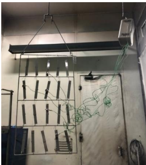
Figura 20 - Sensores e termógrafos posicionados nos corpos de prova antes da entrada na estufa de cura de pintura líquida.
