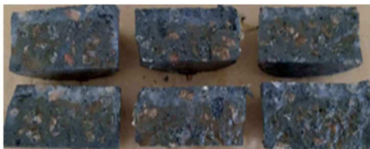
Figura 3.10: Amostras de concreto com aspersão de nitrato de prata.
