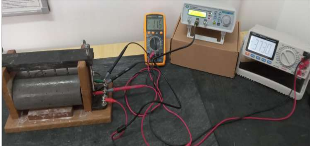
A Figura 3.13: Sonda de quatro elétrodos
