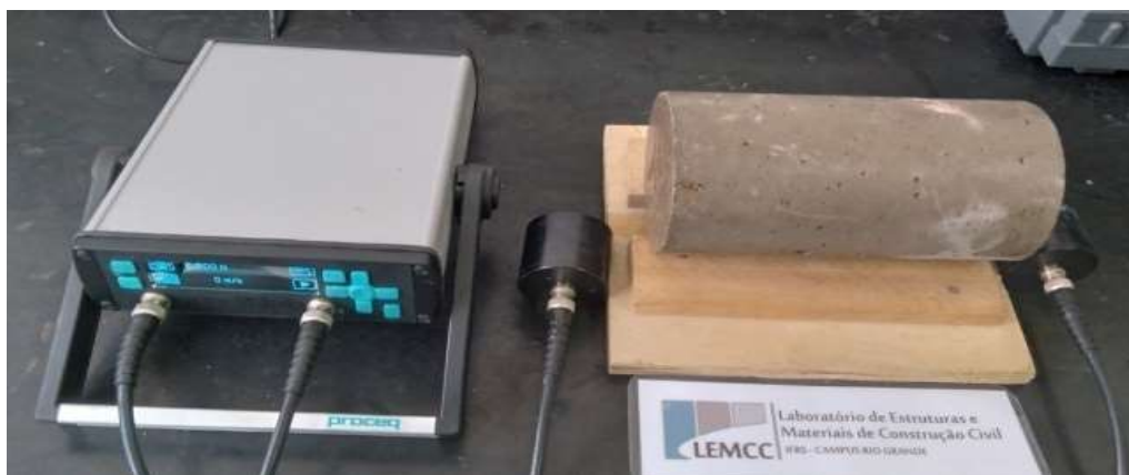
Figura 3.12: Aparelho utilizado no ensaio de velocidade de pulso ultrassônico.
