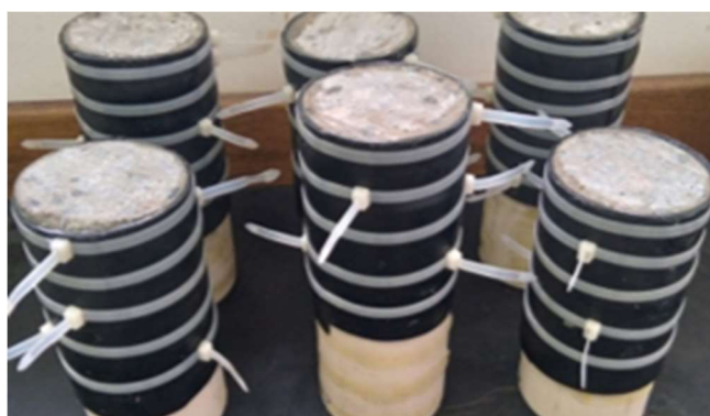
Figura 3.8: Amostras de concreto unidas ao tubo de PVC e a manta de borracha.
