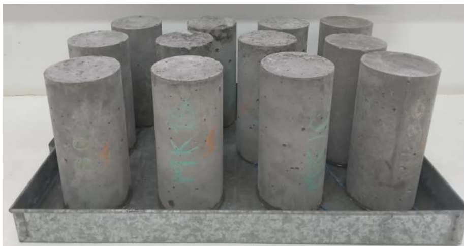
Figura 3.7: Ensaio de absorção de água por capilaridade.
