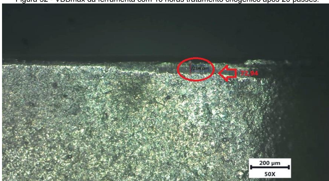
Figura 52 - VBBmáx da ferramenta com 16 horas tratamento criogênico após 20 passes.
