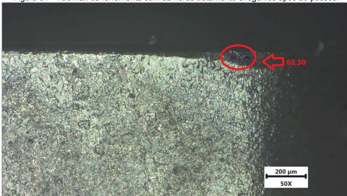
Figura 54 - VBBmáx da ferramenta com 32 horas tratamento criogênico após 20 passes.
