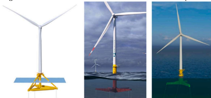
Figura 7. Conceitos de turbinas eólicas flutuantes do tipo TLP.
