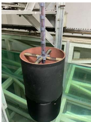
Figura 25. Flutuador com 20 centímetros de diâmetro
