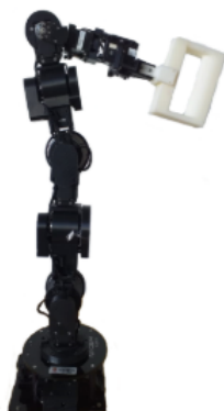
Figura 74: Braço robótico Cyton Gamma 1500 (ROBAI, 2015) com garra adaptada.
