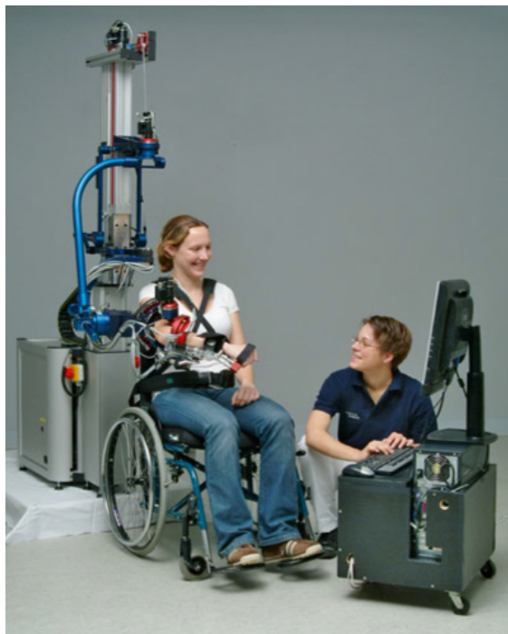
Figura 28: Configuração típica para terapia de braço com suporte de sistema robótico. Retirado de (NEF et al., 2016).
