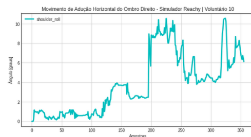
(b) Movimento de adução horizontal do ombro direito reproduzido via simulação do robô Reachy
