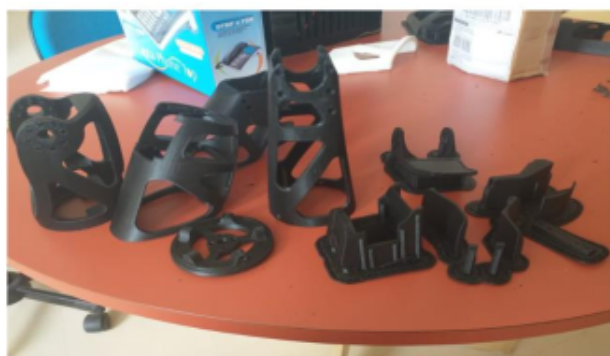
Figura 75: Peças impressas do protótipo baseado no robô Reachy.
