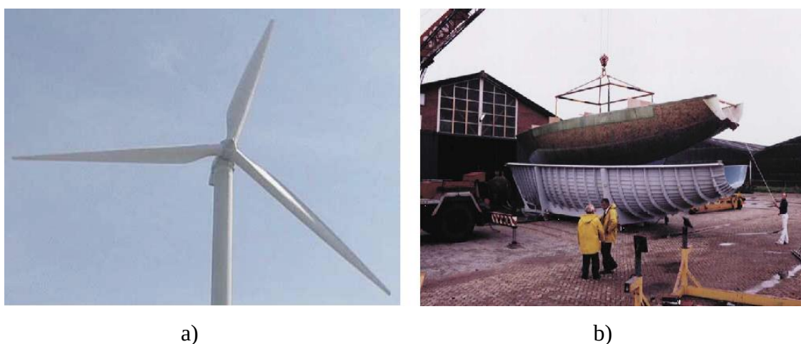
Figura 2.2 – Exemplos de aplicações industriais do processo de LRI nos setores: a) de energia eólica, b) náutico (Brouwer et al., 2003).
