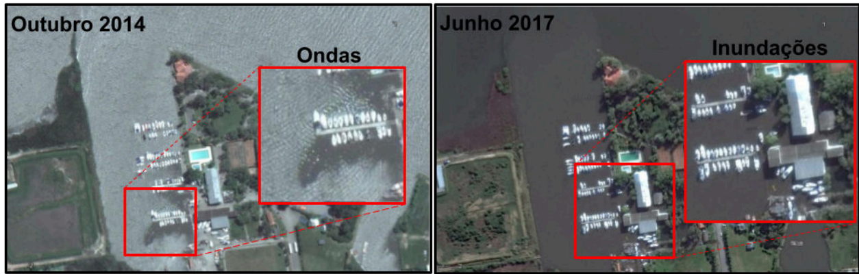
Figura 1.5: Alguns desafios da segmentação semântica de imagens aéreas RGB em marinas: enchentes, ondas na superfície da água provocadas pelo vento, cor da água variável e objetos de tamanhos variados.
