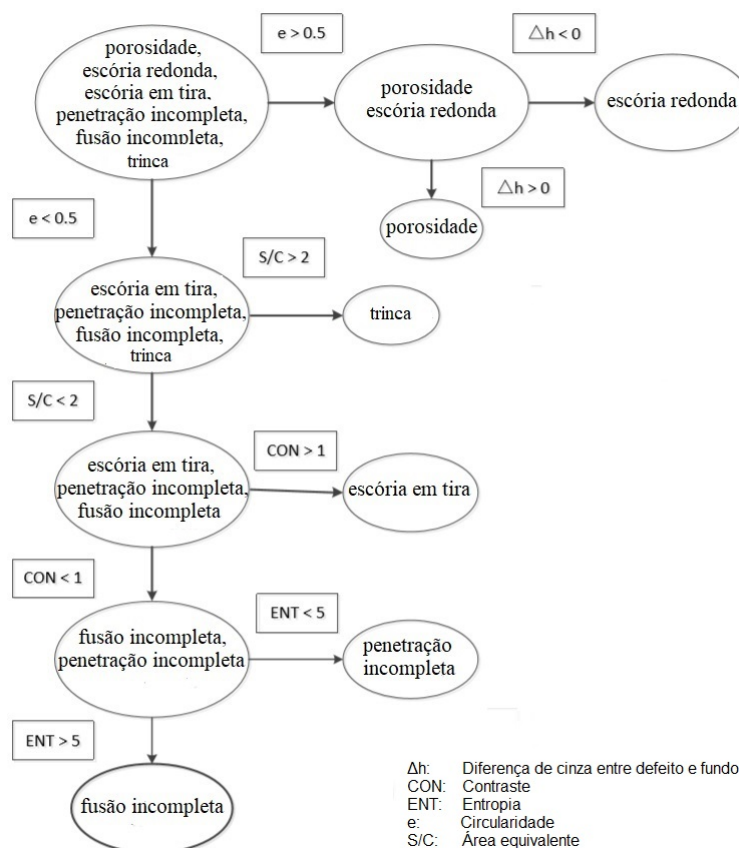
Figura 11: Método de Classificação para Defeitos de Solda (YAN et al., 2017).
