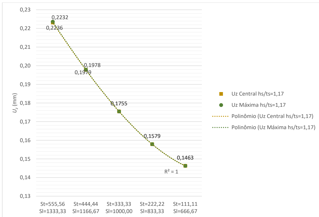
Figura 4.39: Resultados de U_z central e U_z máximo para placa enrijecida P(3,3) e h_s/t_s = 1,17 .
