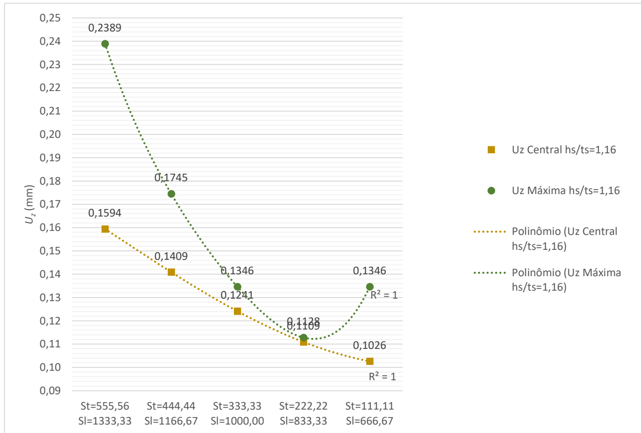
Figura 4.23: Resultados de U_z central e U_z máximo para placa enrijecida P(2,3) e h_s/t_s = 1,16 .
