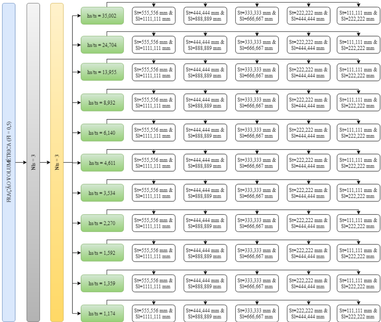
Figura 3.7: Configurações geométricas h_s/t_s para a placa enrijecida P(3,3).
