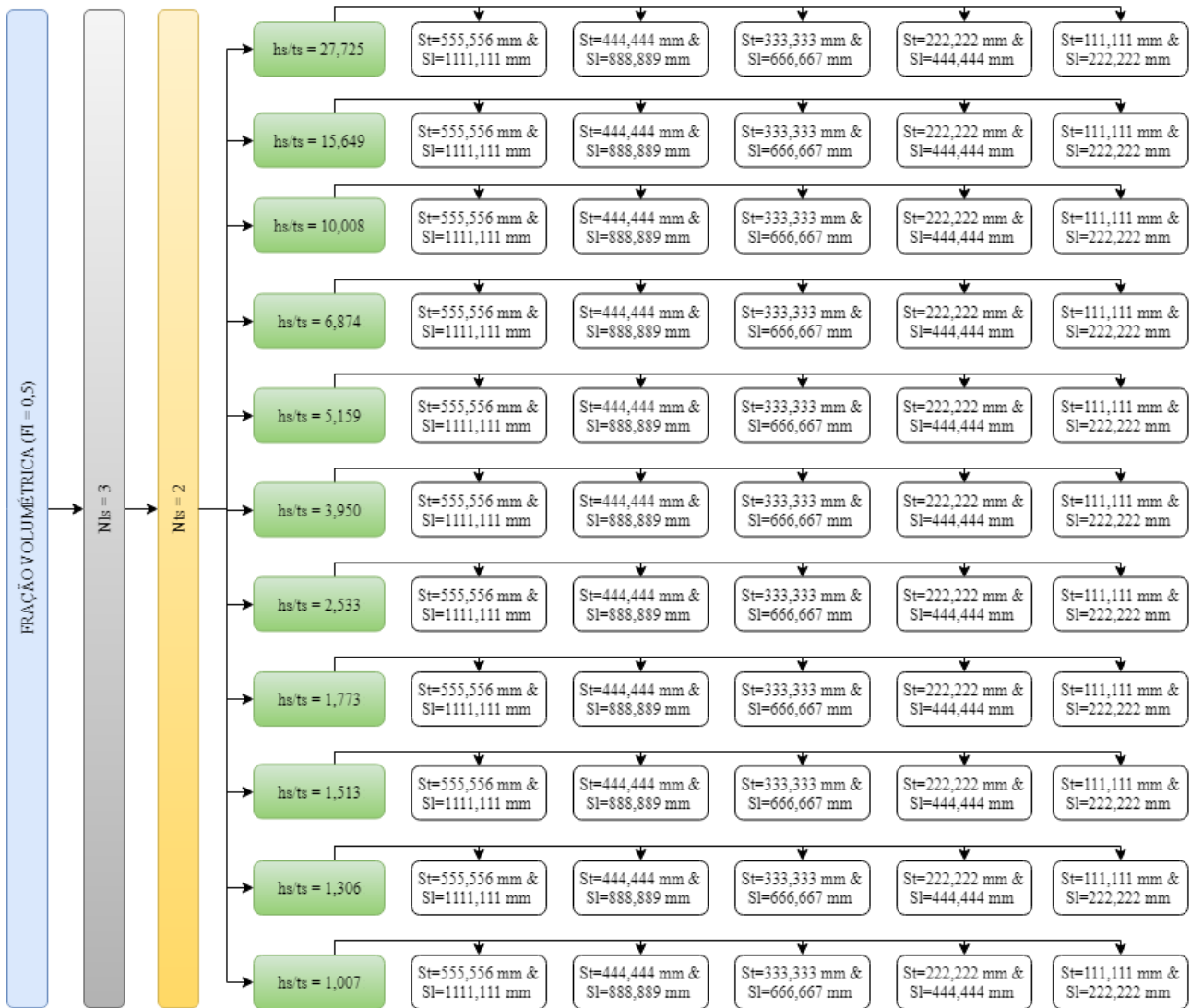
Figura 3.6: Configurações geométricas h_s/t_s para a placa enrijecida P(3,2).
