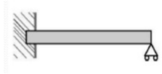
Figura 1.9: Extremidade engastada e outra apoiada.
