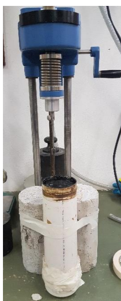
Figura 3.5. Equipamento utilizado no ensaio de palheta de laboratório.
