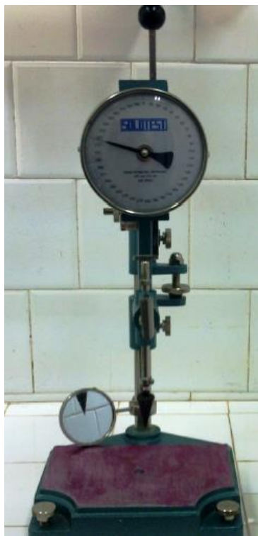
Figura 3.6. Equipamento utilizado no ensaio do cone de queda.
