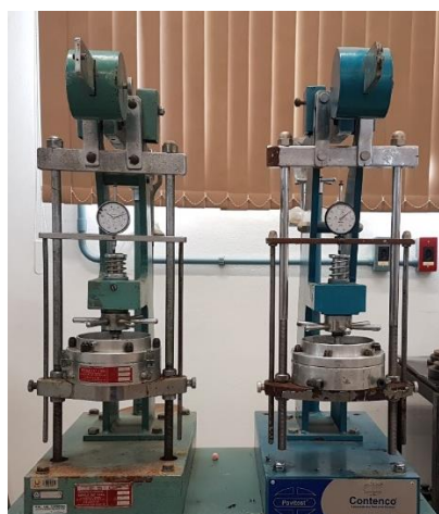
Figura 3.8. Prensas utilizadas no ensaio de adensamento oedométrico.
