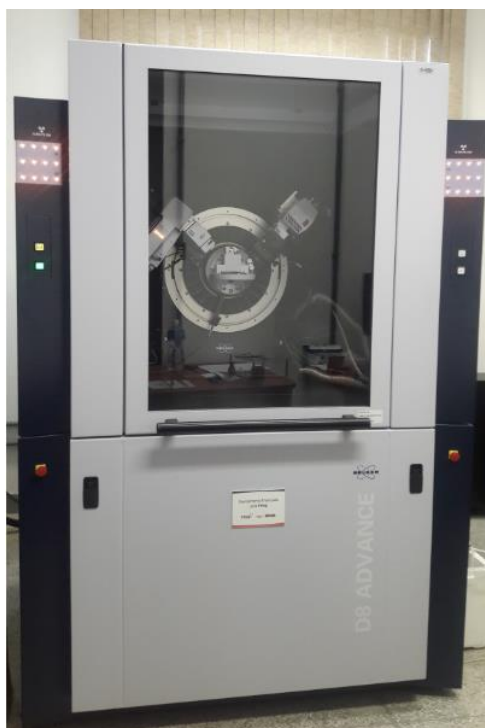
Figura 3.12. Difratorômetro de Raios X com câmara para temperaturas criogênicas, Bruker, D8 Advance. (Fonte: CEME-SUL/FURG)
