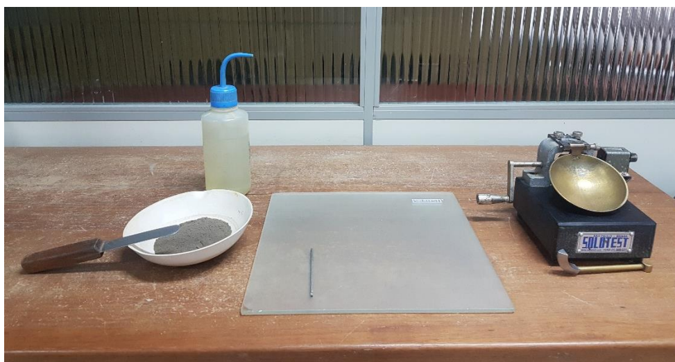
Figura 3.11. Materiais necessários para realização dos ensaios de limite de liquidez e de plasticidade.
