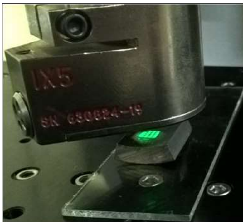
Figura 26 - Medição da profundidade utilizando-se um perfilômetro.
