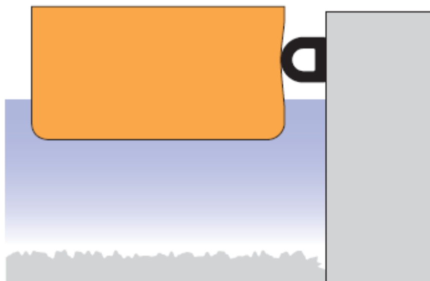
Figura 2.5.3– Definição do coeficiente de amortecimento do casco (Fonte: Manual Trelleborg, 2011, p.22).
