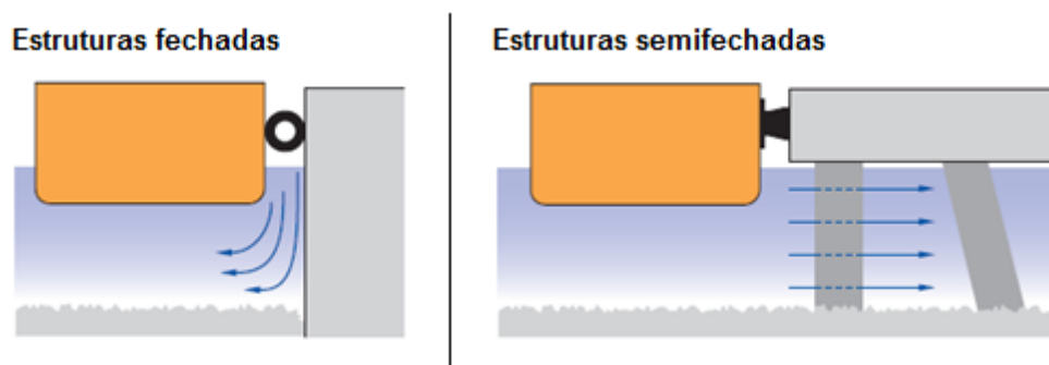
Figura 2.5.4- - Ilustração do coeficiente de atracação (Fonte: Manual Trelleborg, 2011, p.22).
