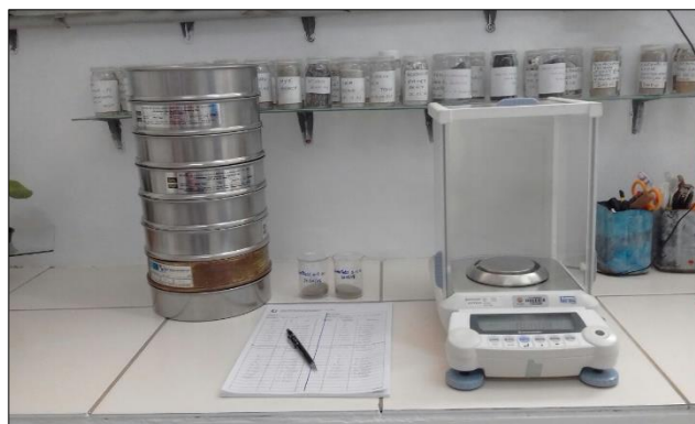
Figura 3 – a) Proveta de 1 litro com material sedimentar menor que 0,063 mm em processo de decantação. b) peneiras empilhadas de acordo com os tamanhos 4, 2, 1, 0,5, 0,25, 0,125, 0,062 mm e fundo juntamente com a balança utilizada.
