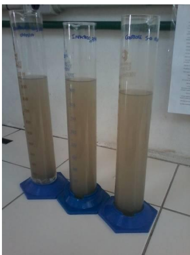
Figura 3 – a) Proveta de 1 litro com material sedimentar menor que 0,063 mm em processo de decantação. b) peneiras empilhadas de acordo com os tamanhos 4, 2, 1, 0,5, 0,25, 0,125, 0,062 mm e fundo juntamente com a balança utilizada.
