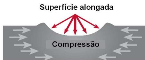
Figura 5 - Esquema da deformação superficial pelo processo Shot Peening
