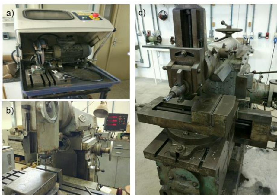
Figura 18 - Máquinas utilizadas para a fabricação das amostras – a) Cortadeira metalográfica – b) Fresa de topo – c) Plaina
