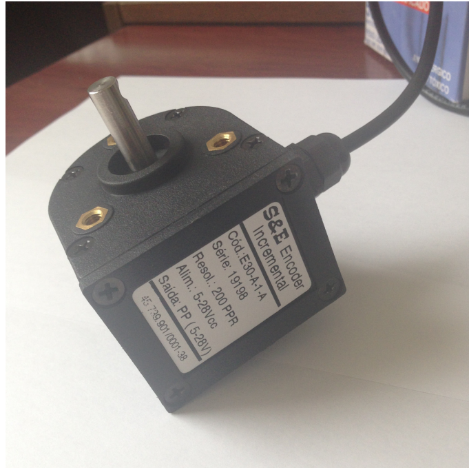
Figura 35: Encoder utilizado no sensor de velocidade.
