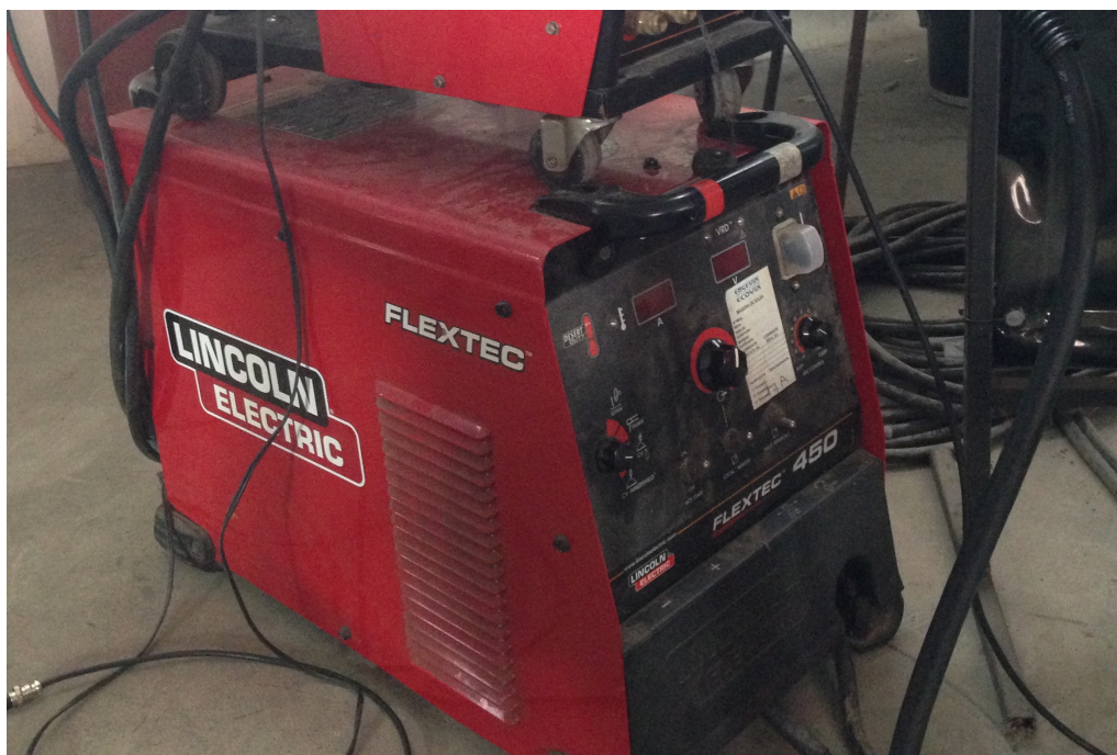
Figura 21: Fonte de energia Flextec 450.
