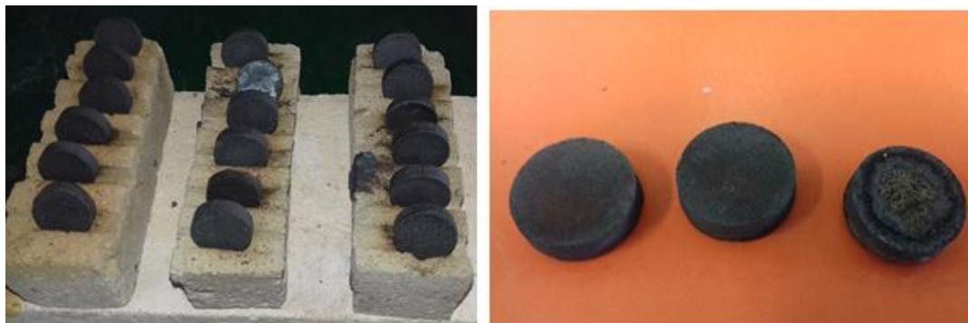
Figura 22: Sinterizados já resfriados a temperatura ambiente.
