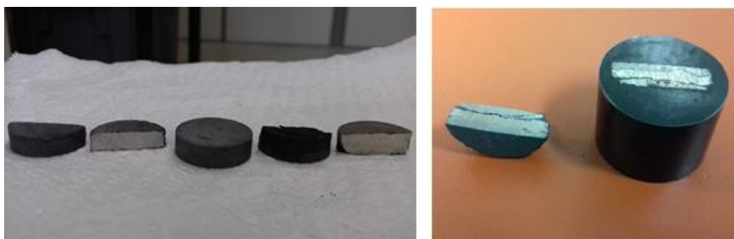
Figura 23: Ilustração do corte e embutimento de alguns corpos de prova da liga formada.
