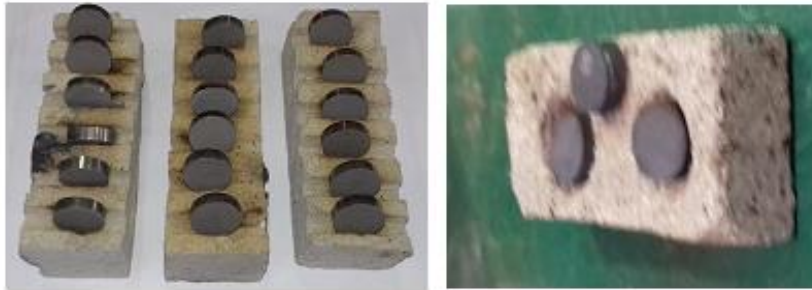
Figura 20: Tijolos usados para inserção do compactado no forno EDG 3000.
