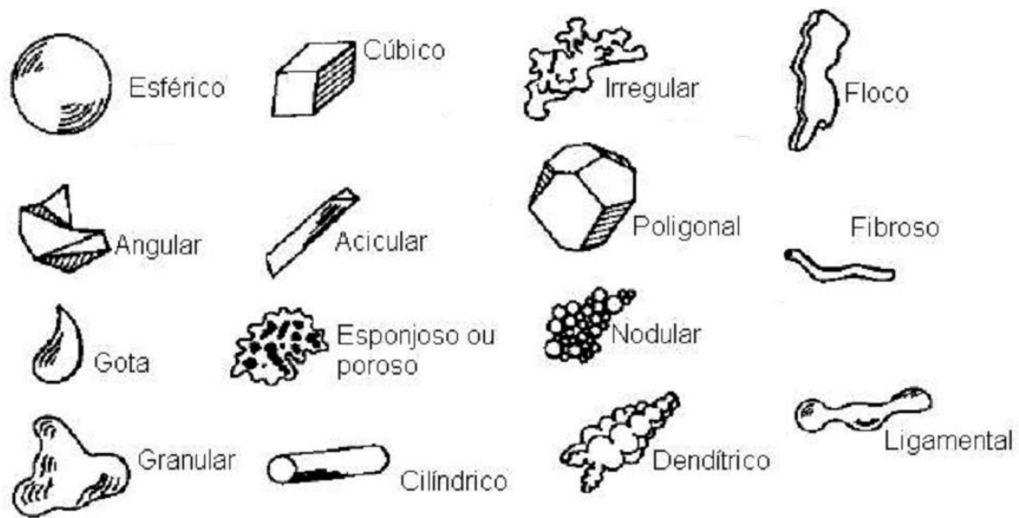
Figura 1: Formas de partículas de acordo com diferentes métodos de obtenção do pó.
