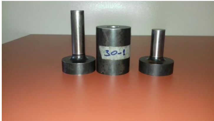
Figura 19: Ilustração da matriz usada para compactação dos pós.
