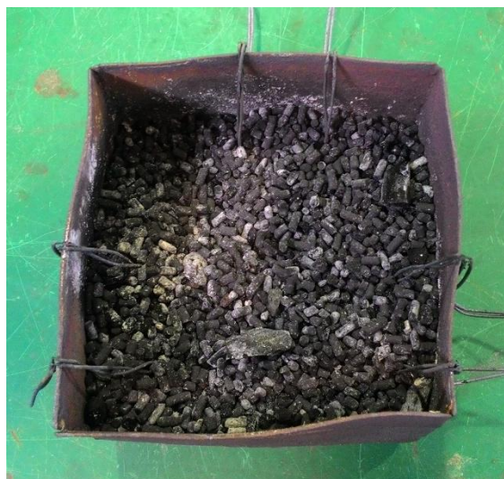
Figura 11 – Simulação da atmosfera carburizantes.
