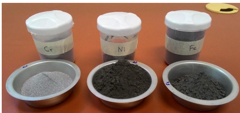
Figura 7 – Pós elementares de Cr, Ni e Fe.
