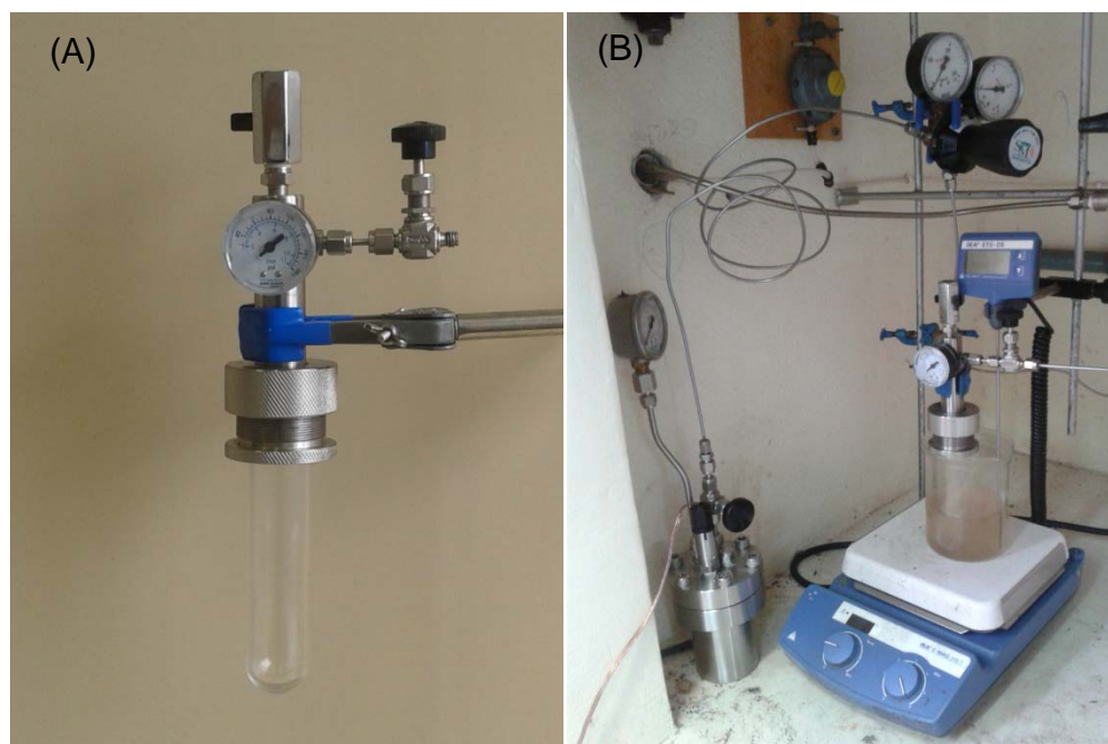
Figura 20. Esquema experimental utilizado na síntese de NPs de Ir(0) e testes catalíticos: (A) Reator de Fischer- Porter (B) Sistema reacional.
