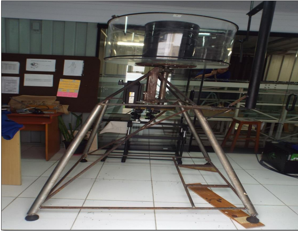
Figura 4.10 - Estrutura do canal circular
