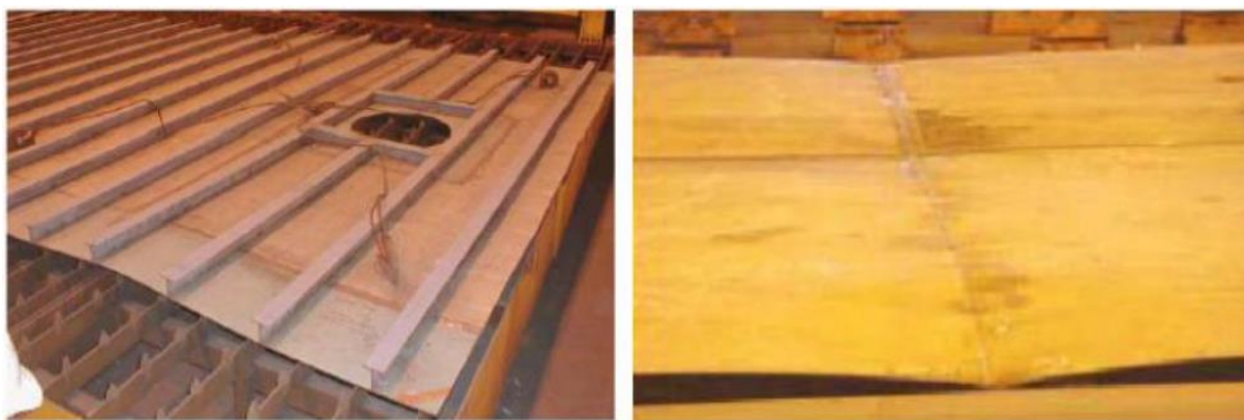
Figura 1.3 –Imperfeições geométricas iniciais (Amante, 2009)
