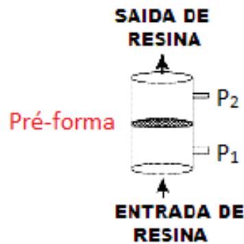
Figura 2.5 - Método de medição da permeabilidade transversal. Adaptado de Amorim, (2007).
