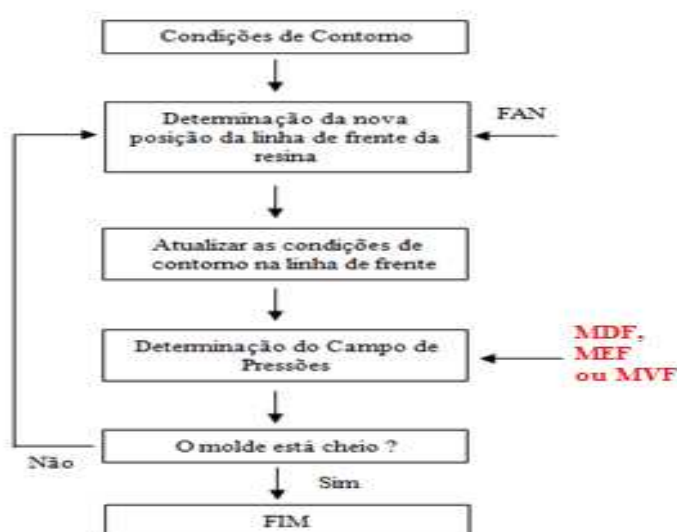
Figura 2.1 - Fluxograma do algoritmo numérico. Adaptado de Oliveira (2010).
