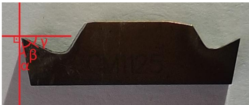
Figura 31 - Esquema dos ângulos da ferramenta.
