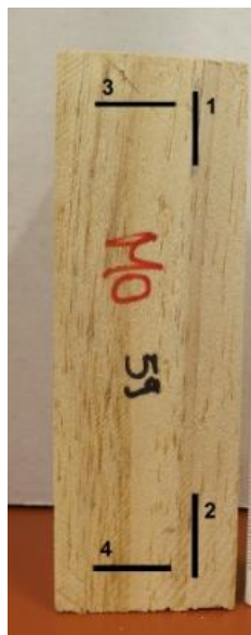
Figura 27 – Pontos de análise da rugosidade, sendo 1 e 2, medida longitudinal; 3 e 4, medida transversal.
