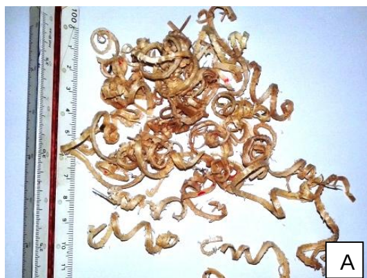
Figura 42 – Cavacos formados pelos corpos de prova do lenho adulto: testemunha (A), 160°C (B), 180°C (C), 200°C (D) e 220°C (E).
