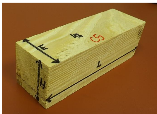
Figura 24 – Indicação das dimensões no corpo de prova.
