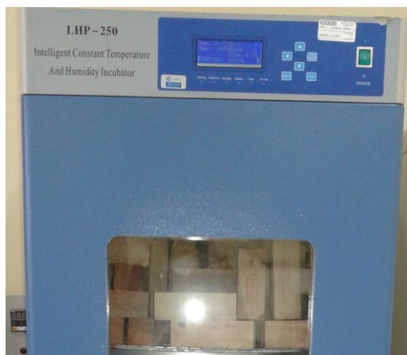
Figura 25 – Distribuição dos corpos de prova na câmara climática.
