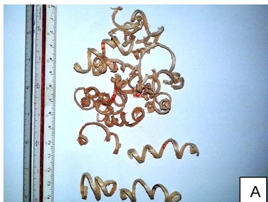
Figura 43 - Cavacos formados pelos corpos de prova do lenho juvenil: testemunha (A), 160°C (B), 180°C (C), 200°C (D) e 220°C (E).
