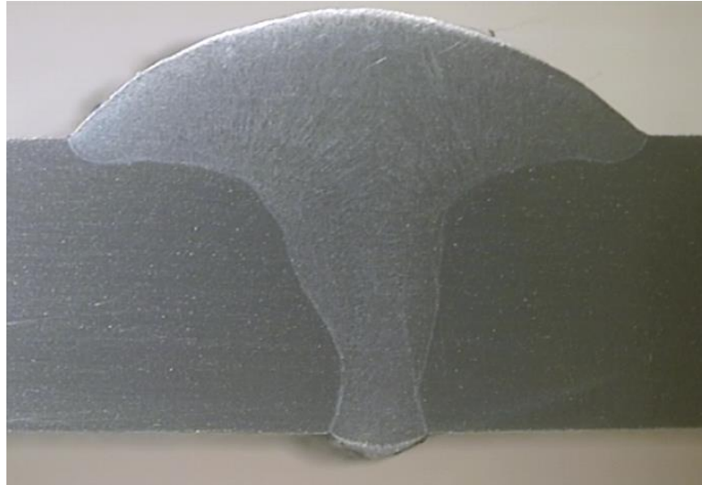
Figura 46 – Macrografia da seção transversal do cordão de solda (espessura = 6mm)
