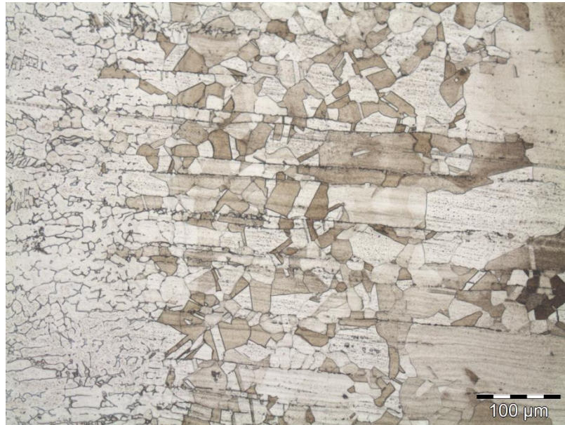
Figura 482 – Micrografia da zona fundida com detalhe do modo de solidificação A + F
