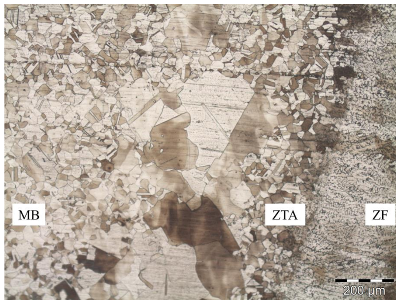
Figura 460 – Micrografia da ZTA próxima a raiz do cordão de solda
