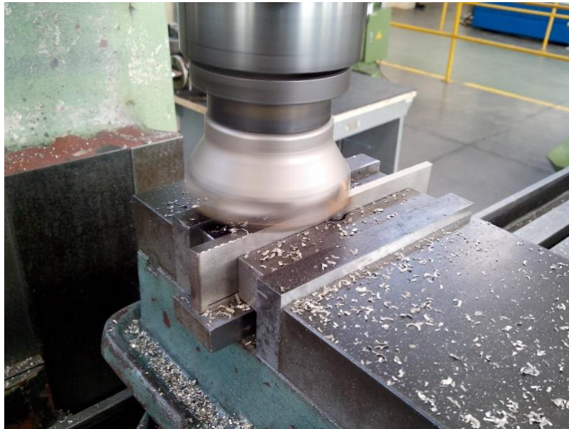
Figura 37 – Preparação corpo de prova soldado
