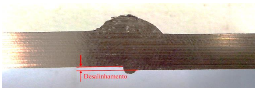
Figura 45 – Desalinhamento entre chapas após realização do cordão de solda (espessura = 6mm)
