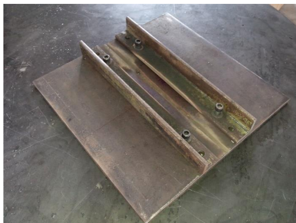
Figura 34 – Suporte de fixação para soldagem
