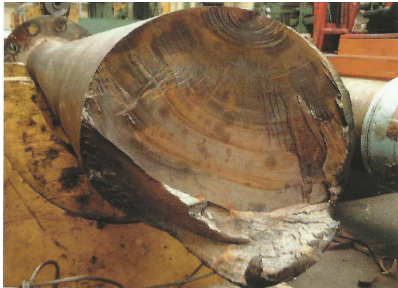
Figura 19 – Eixo naval fraturado por fadiga mecânica
