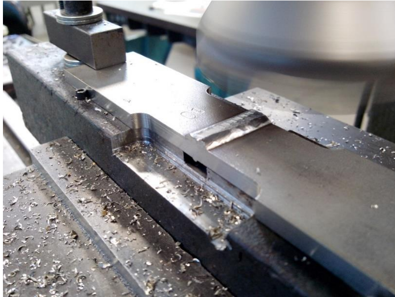
Figura 41 – Fresagem reforço e raiz do cordão de solda
