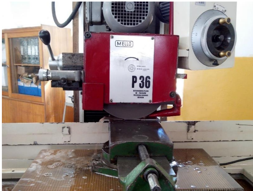
Figura 42 – Retificação corpos de prova
