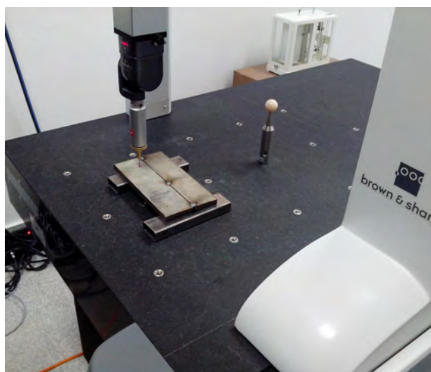
Figura 25 – Um dos corpos de prova para medição na máquina de medição por coordenadas
