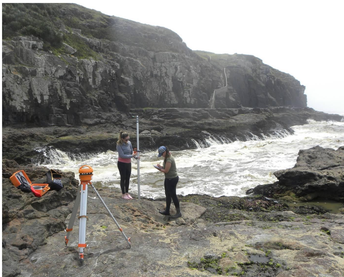
Figura 4.3 – Medição da inclinação do costão do Morro das Furnas (Torres – RS), com um Nível a Laser.
