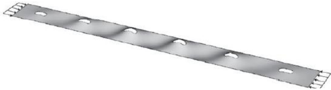
Figura 1.3 – Placa com múltiplos furos, comprimida uniformemente (Moen e Schafer, 2009).
