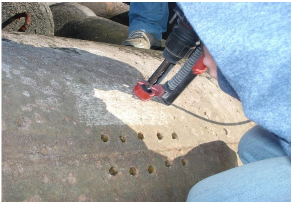
Foto 3.5 – Furadeira utilizada na extração das amostras micro-ambiente MLLS aos 9,5 anos e os 10 furos realizados aos 5 anos.
