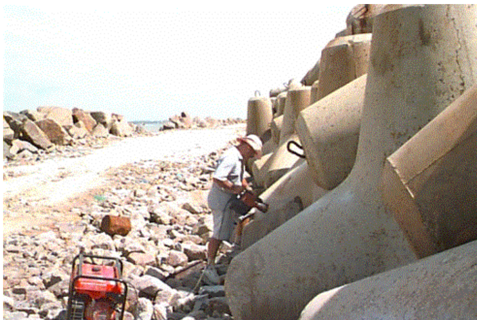
Foto 3.14 – Extração das amostras de concreto no ponto MLOI na idade de 5 anos.
