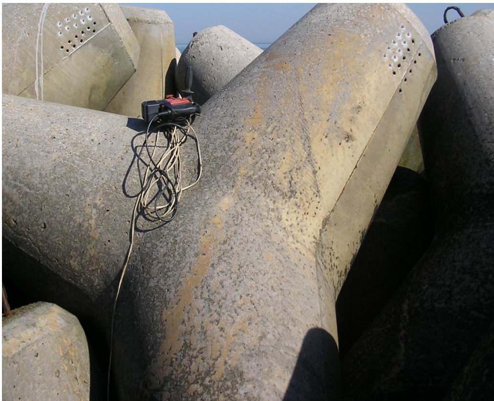
Foto 3.11 – Os dois tetrápodes que compõem o ponto MLLS - 20 furos referentes à extração de material aos 5 e aos 9,5 anos de idade.
