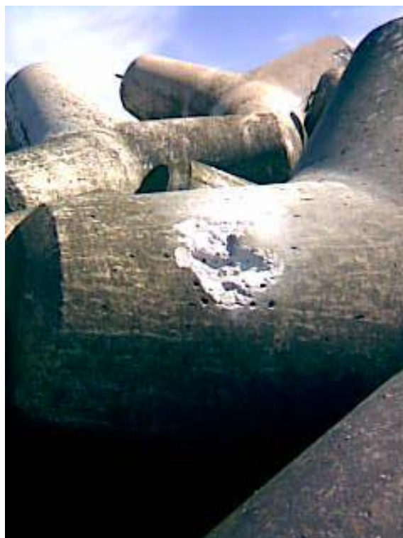
Foto 3.19 – Retirada das amostras de concreto junto aos furos onde foram coletadas as amostras das idades de 5 e 9,5 anos (micro-ambiente MLLM).
