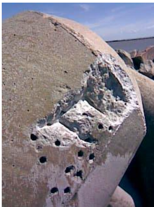
Foto 3.17 – Retirada das amostras de concreto junto aos furos onde foram coletadas as amostras nas idades de 5 e 9,5 anos (micro-ambiente MLLS).
