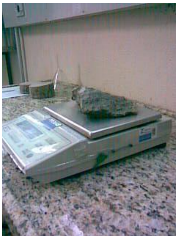
Foto 3.20 – Pesagem das amostras no dia da extração
