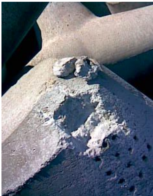
Foto 3.18 – Retirada das amostras de concreto junto aos furos onde foram coletadas as amostras das idades de 5 e 9,5 anos (micro-ambiente MLOI).
