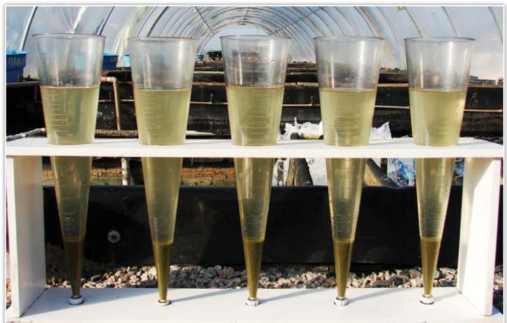
Neste trabalho a formação dos bioflocos ocorreu de forma proporcional aos tratamentos, ou seja, quanto maior a proporção utilizada, mais rápida ocorreu a formação de bioflocos, conforme pode ser observado na **figura 5**. Como esperado, a quantidade de sólidos suspensos totais na água foi proporcional ao volume de bioflocos que foi reutilizado em cada tratamento, exceto no tratamento 25%, onde as concentrações mantiveram-se próximas aos níveis do tratamento controle.
